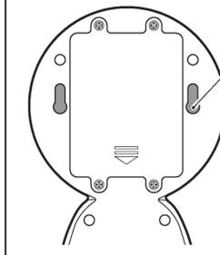
壁などに設置する際は、壁に取り付けたネジに本体をセットしてください。
