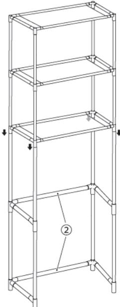
**⚠注意** 完成後に便器の背面にセットできない場合は上記の②のパイプ2本を一旦取り外して、設置後に便器の背面で再度セットしてください。
