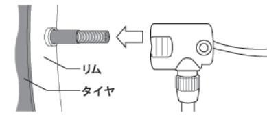
①ロックレバーを起こした状態でバルブに米式口金(上側の穴)を差し込む。
