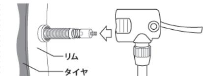
②ロックレバーを起こした状態でバルブに仏式口金(下側の穴)を差し込み、ロックレバーを倒して、口金を固定する。
