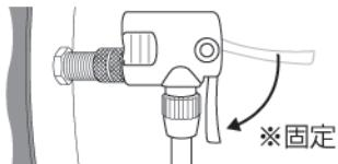
②ロックレバーを倒して、口金を固定する。
