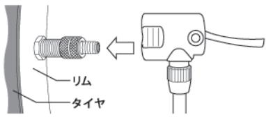
①ロックレバーを起こした状態でバルブに英式口金(下側の穴)を差し込む。
