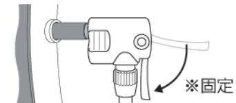
②ロックレバーを倒して、口金を固定する。
