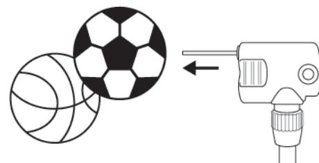
③ボールの空気栓に差し込み、適正な空気圧になるまで、繰り返しポンピングして空気を注入する。
