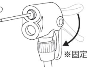
②ロックレバーを倒して口金を固定する。
